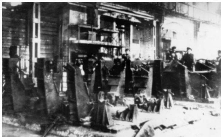
(Часть 1). Стенды для сборки корпусов танков в пятом пролете бронекорпусного цеха.
