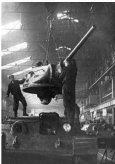
(Часть 2). Производится установка башни с пушкой на танк.
