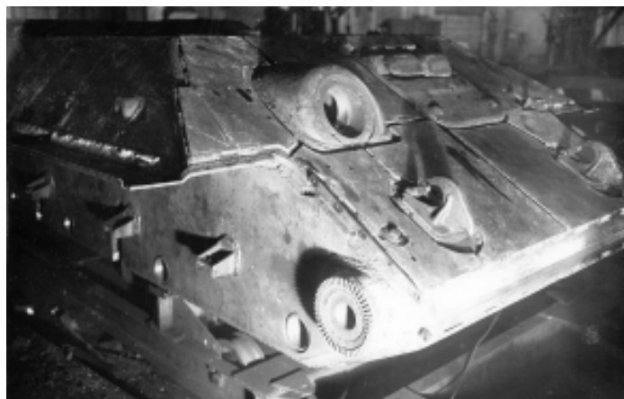
Экранирование дополнительной броней корпусов танков в бронекорпусном цехе.
