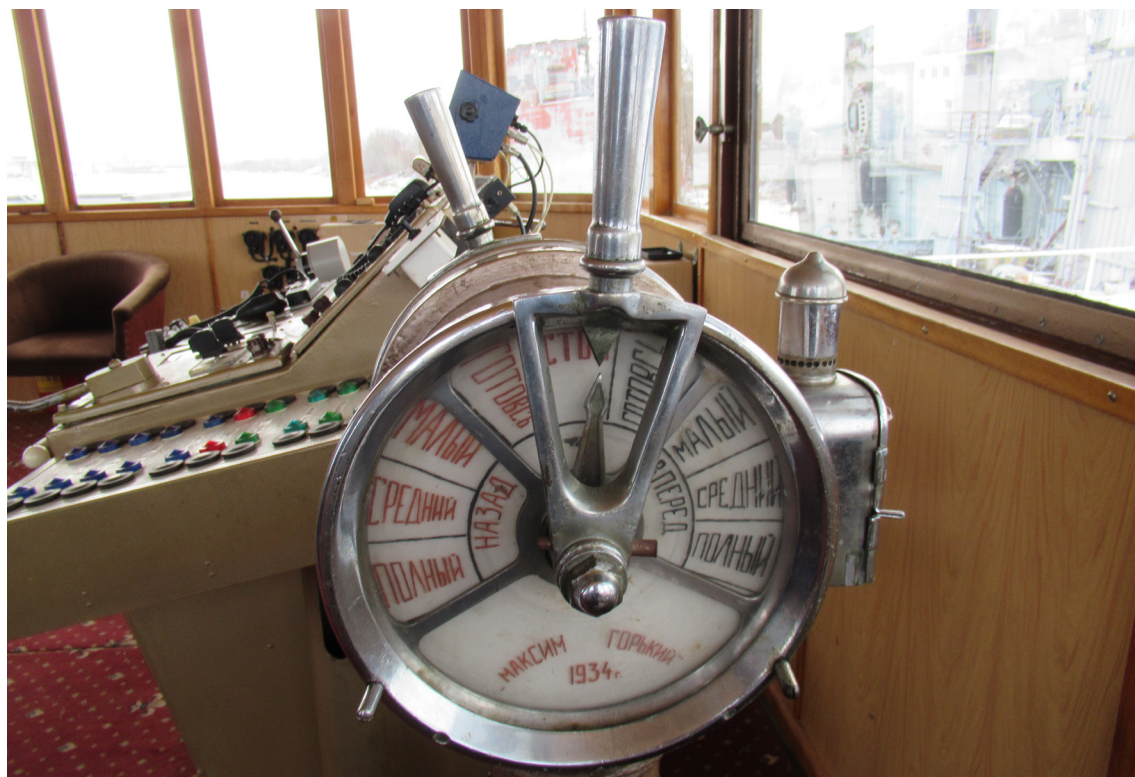
Машинный телеграф для передачи команд из ходовой рубки в машинное отделение
