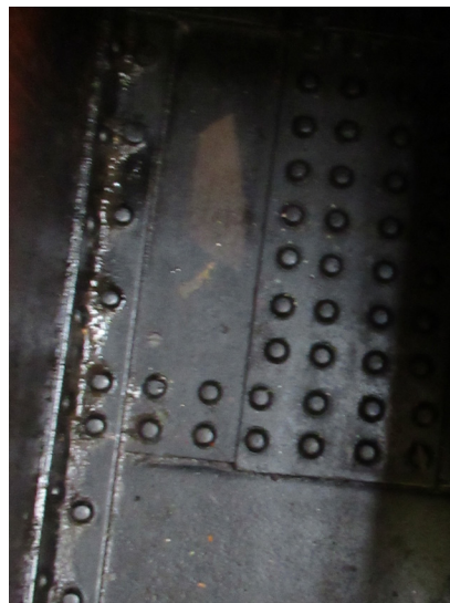
Сормовская клёпка корпуса судна
