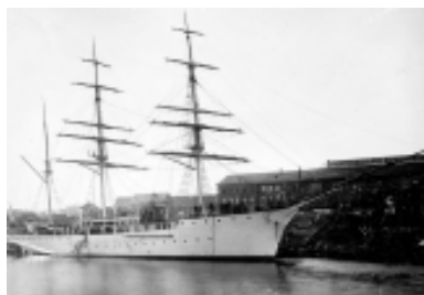
Катер «Ксения» для Черноморского флота. Длина 52,7 м, ширина 9,15 м, борт 4,5 м, осадка 3,05 м, водоизмещение 792 м 3 , площадь парусов 766 м 2 , паровая машина 120 л.с., паровой котел, рефрижераторная машина прачечная, вентиляция, хлебопекарня.)
