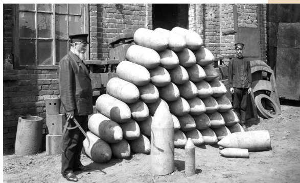
Замер кронциркулем болванок снарядов. Фото М.П. Дмитриева. 1915
